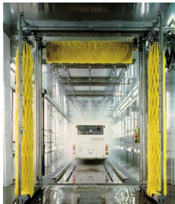
Zkoušky těsnosti skeletu autobusů (2000)
