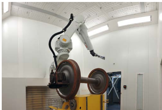
Robotické lakování železničních dvoukolí RYKO Děčín
