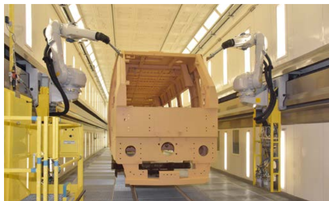
Robotické lakování vagonů ALSTOM Česká Lípa
