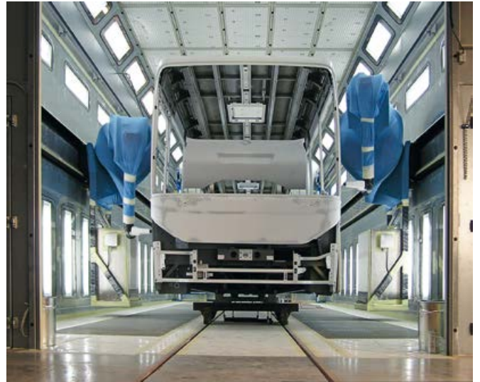
Robotická lakovací kabina, IVECO Vysoké Mýto
