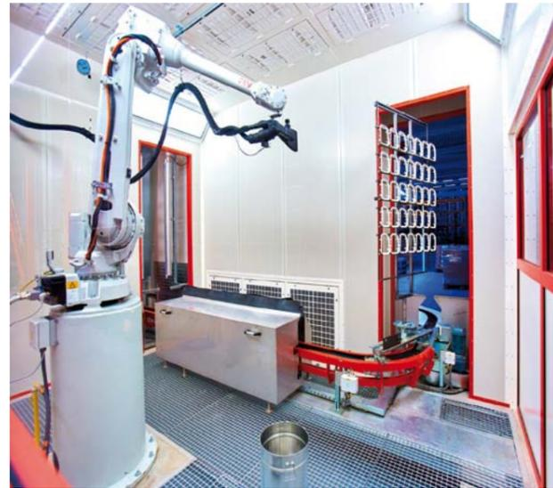
flüssigen Beschichtungsstoffen erfolgt in zwei Spritzkabinen mit Wasserfiltern. Die technische Lösung der einzelnen Arbeitsbereiche ermöglicht die Applikation auch der anspruchsvolleren Beschichtungssysteme, wie z.B. Hochglanzfarben (sog. „high-gloss“ Farben).
