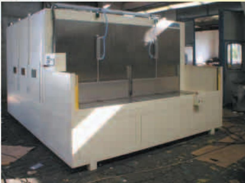
Pec je vybavena pneumatickými manipulátory, které zajišťují veškerý pohyb dílců v peci, jeho zavezení do pece, plynulé zakládání a snímání ve správné poloze.
