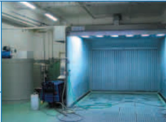
**D** o konce tohoto roku bude, na základě smlouvy uzavřené s firmou **Jaroslav Cankař a syn ATMOS Bělá pod Bezdězem**, v nově vybudovaných výrobních prostorech, zprovozněna linka pro povrchovou úpravu kotlů rozpouštědlovými nátěrovými hmotami.
