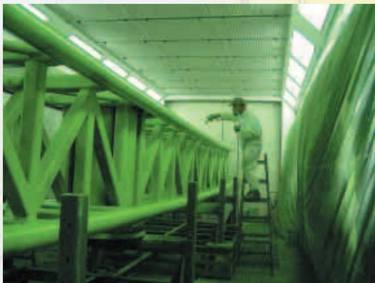
Celý provoz se skládá ze zděné roštové stříkací kabiny s velikostí pracovního prostoru 5x14,4x3,4 m (šxlxv), vestavku pro umístění strojovny vzduchotechniky a úpravný nátěrových hmot. Prostor kabiny je z hlediska tepelných izolací obložen z vnitřku izolovanými panely. Kabina je připravena pro umístění pneumatických plošin obsluhy.
