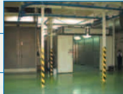
**V** březnu letošního roku předala naše společnost do užívání **SLOVÁCKÝM STROJÍRNÁM, a.s. Uherský Brod** pracoviště pro nanášení rozpouštědlových nátěrových hmot včetně zachytu plyných znečišťujících látek a pracoviště pro odmašťování ocelových dílů.
