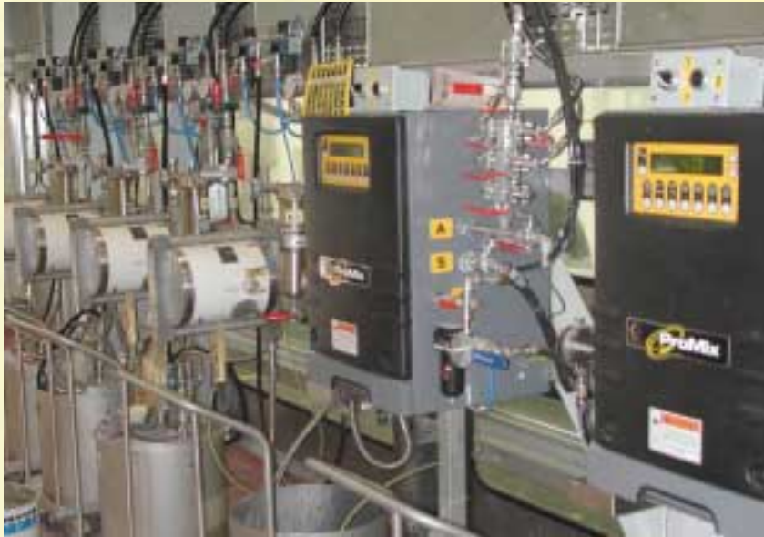
Dvoukomponentní, elektronicky řízené zařízení GRACO PROMIX s centrálním zásobováním barvou s možností sledování statistiky přesnosti míchání a spotřeb pro účely systému řízení jakosti a kalkulace nákladů.
