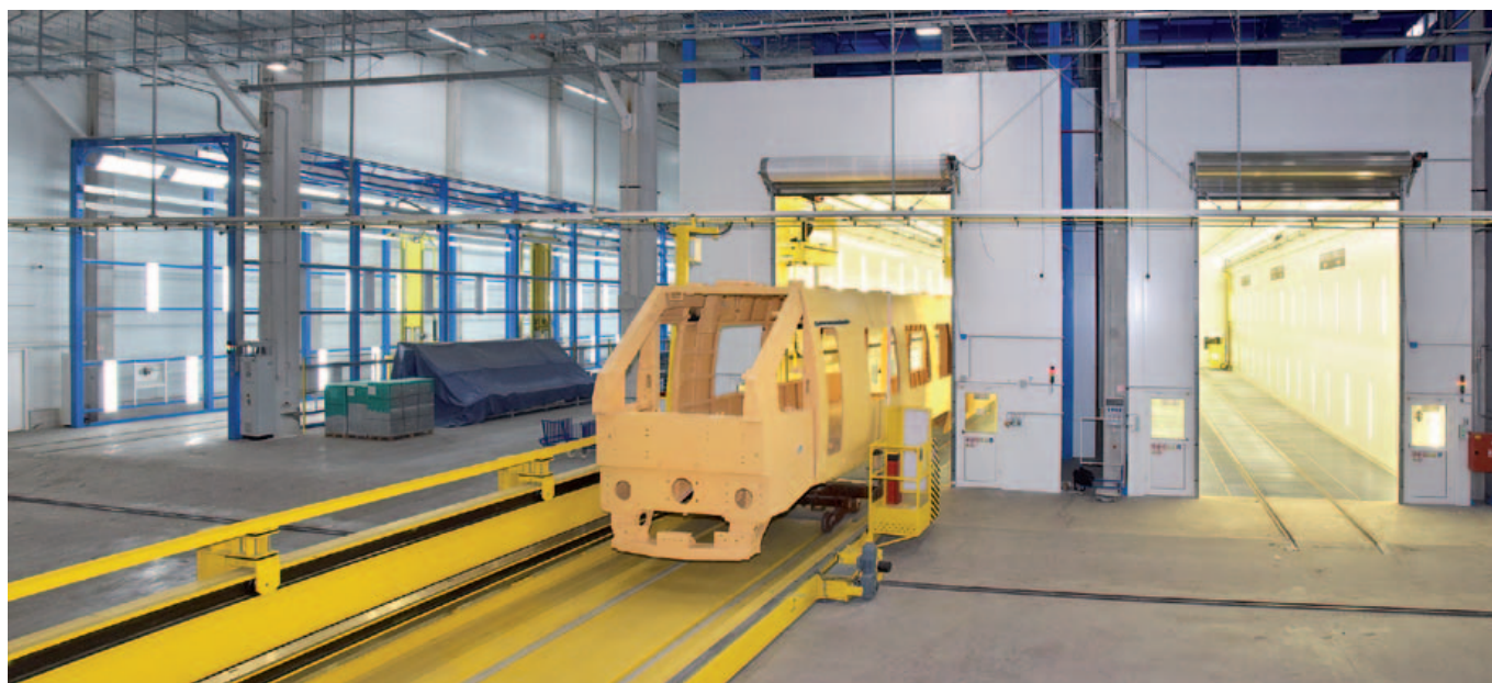
Zavážení skeletu do robotické lakovny
