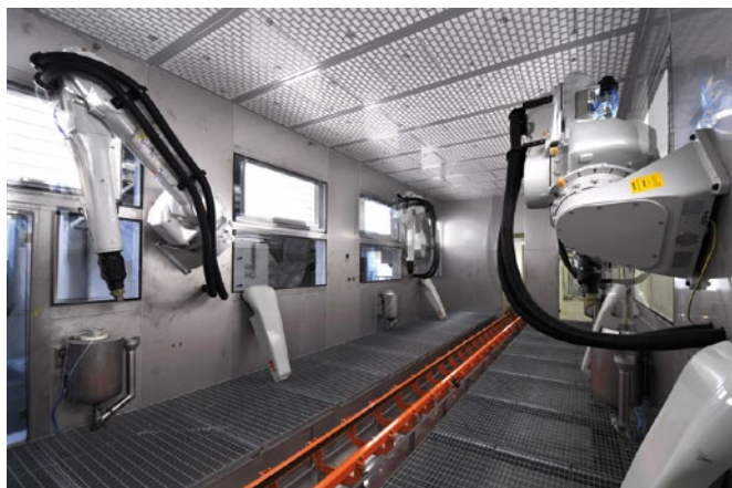
Lakovací kabina - aplikace BASECOAT
