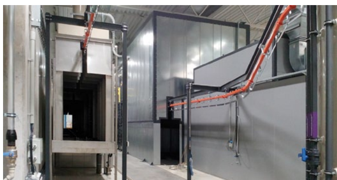
Pohled na odmašťovací stroj a vytvrzovací pec
