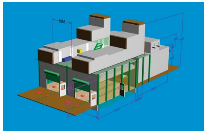
Celkový pohled na lakovací linku Volkswagen Wrzesnia
