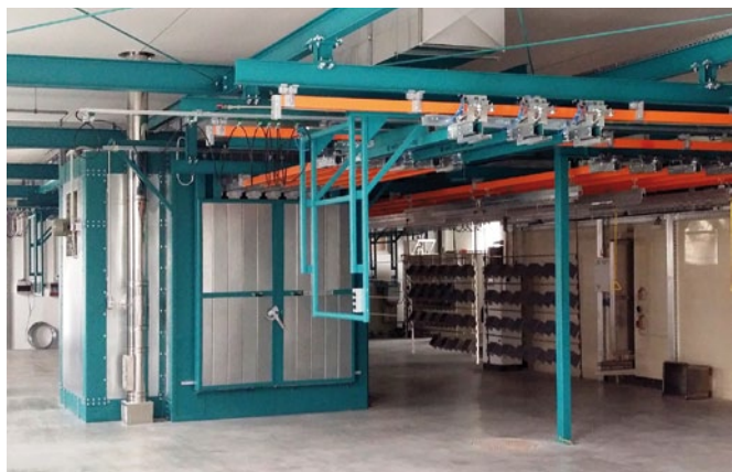
Linka pro nanášení práškových plastů pro COMWA spol. s r.o., Přeštice
