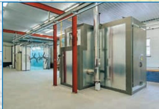
**D**íly automatických dveřních systémů budou ještě letos povrchově upravovány v PARS Komponenty s.r.o. Studénka. Na novém pracovišti povrchových úprav, složeném ze stříkací roštové kabiny, plynové sušárny, ručního dopravního systému, brousícího pracoviště, přípravy nátěrových hmot a záchytu plyných emisí.
