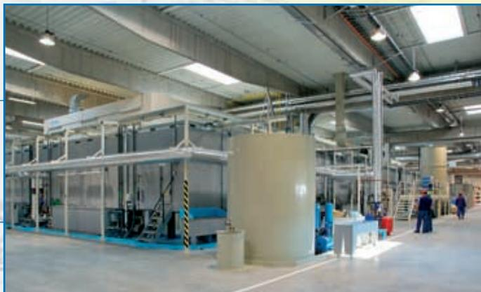
**L**etos v březnu byla v Plzni předána do užívání kompletní linka pro nanášení fasádních polyesterových práškových plastů společnosti DAIKIN INDUSTRIES CZECH REPUBLIC s.r.o.. Při rychlosti 4,5 m/min jsou v automatickém režimu lakovány kryty klimatizačních jednotek.
